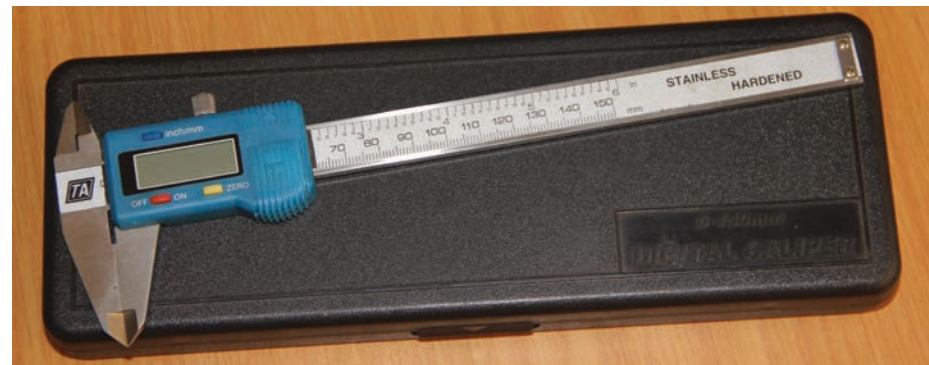
'n Skuifpasser (verkieëlik elektronies) is onontbeerlik vir herlaai, want doppe en patroonlengtes moet gereeld gemeet word.
